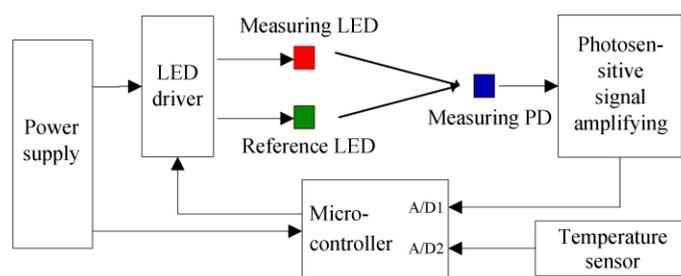
图 2 红外甲烷传感器系统原理框图
