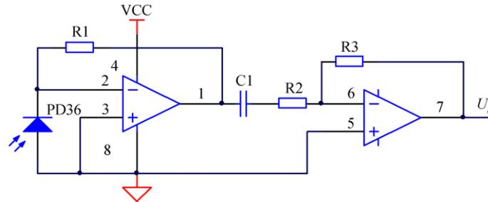
图 6 光敏信号处理电路
