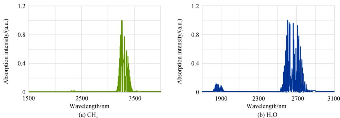
图 1  $\text{CH}_4$ 、 $\text{H}_2\text{O}$  在  $3.3\ \mu\text{m}$  附近的吸收光谱
