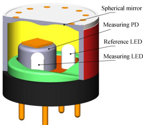
图4 采样气室设计示意图
