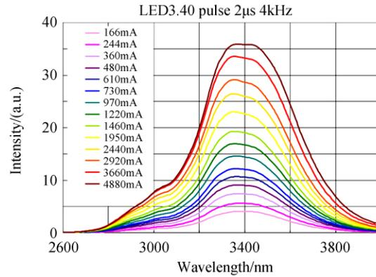
图 5 LED34 不同电流下的发射光谱
